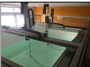
Bassin d'essais pour des expérimentation de transmission et de positionnement par ondes acoustiques ou caractérisation de transducteurs.
